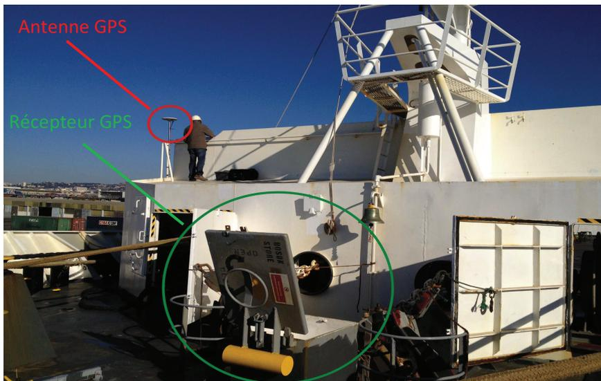
L'antenne GPS a été placée sur l'avant du navire dans le but de minimiser au maximum les masques qui pourraient altérer les mesures GPS. La cale du bateau symbolisée par le cercle vert sur l'illustration 2 est située à l'avant du bateau. Elle contient le récepteur GPS, l'antenne et le récepteur sont reliés par un câble.
