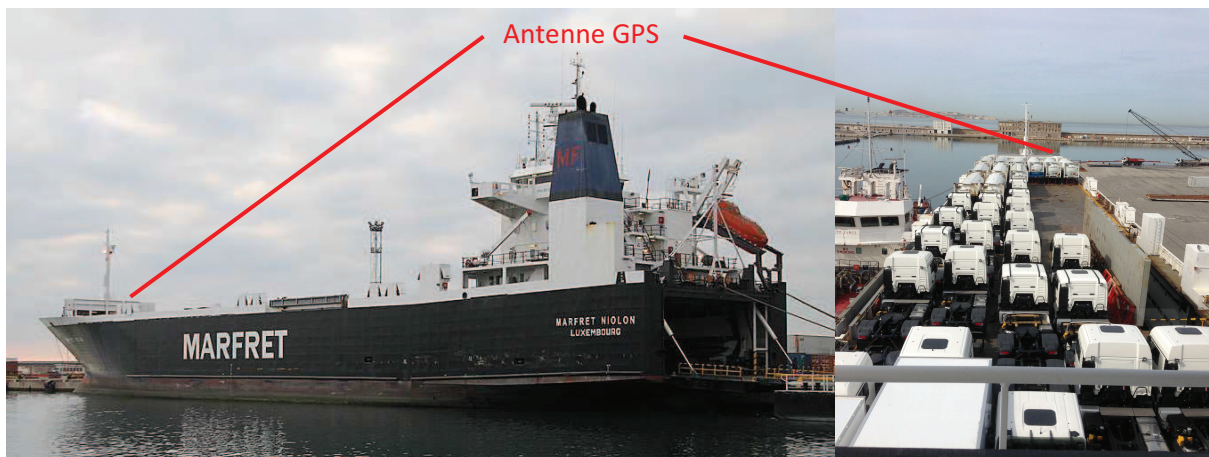
Illustration 1 : Photographies du Marfret Niolon et position de l'antenne sur le navire.
