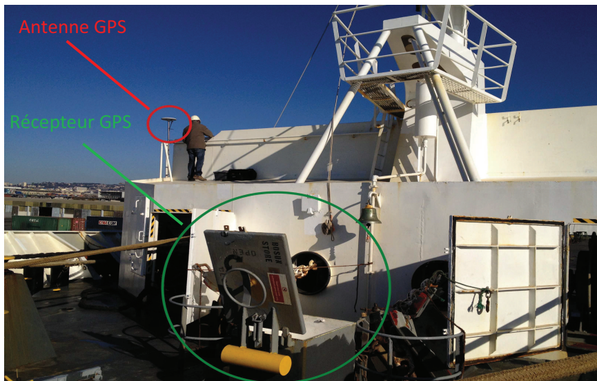
Illustration 2 : Description du dispositif installé sur le Marfret Niolon.
