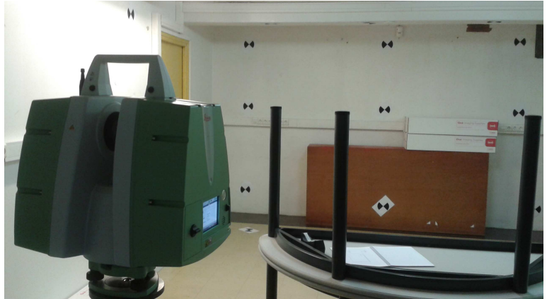
Figure 28 : Pièce servant à l'auto-calibration
