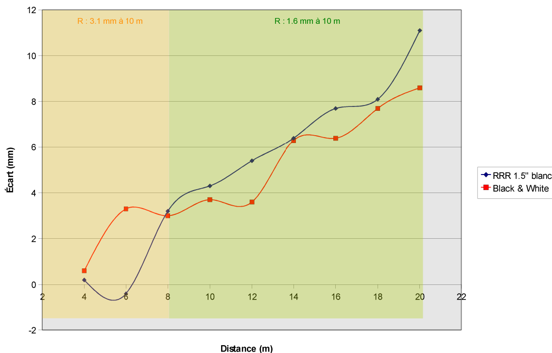
Figure 14 : Écart entre les dénivelés obtenus avec le HDS6200 et la TDRA6000 en fonction de la distance scanner-cibles
