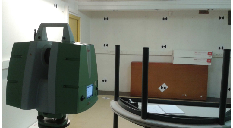
Figure 28 : Pièce servant à l'auto-calibration
