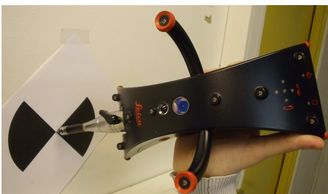
Figure 29 : Mesure d'une cible B&W avec le T - Probe
