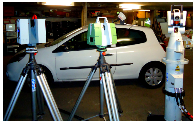
Figure 3 : La voiture mesurée avec les différents instruments de mesures utilisés (les scanners laser HDS6200 et P20, le T-Scan + la T-Cam associés au laser tracker LTD800)
