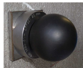
Figure 5 : Partie sphérique du RRR 1,5"
