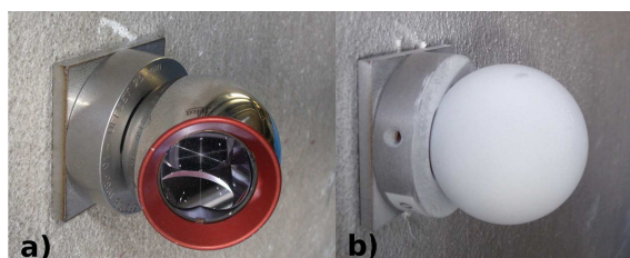
Figure 6 : Le RRR 1,5" métallisé (a) et poudré en blanc (b)
