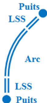
Figure 3 : Schéma d'un secteur du LHC
