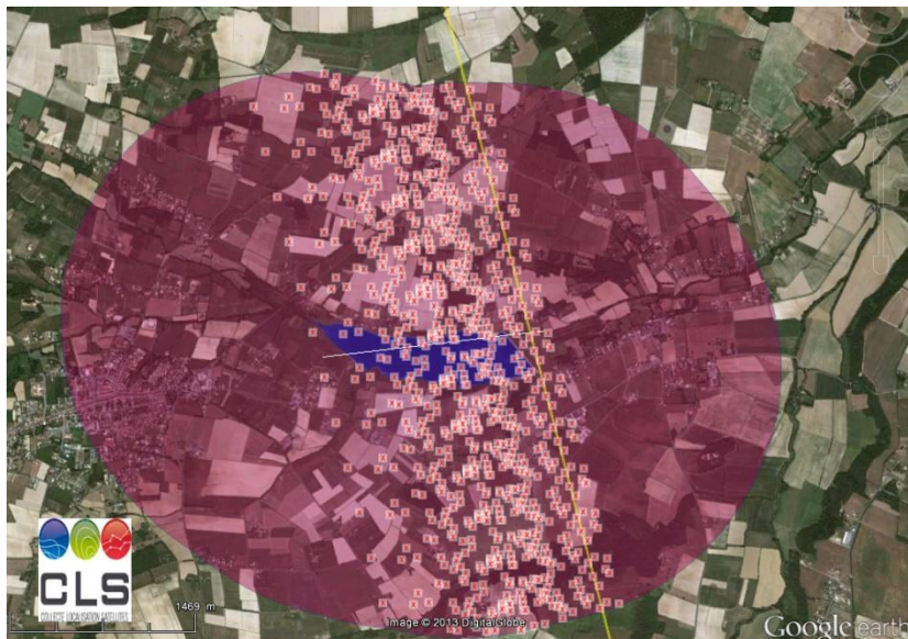
Figure 20 : exemple de station virtuelle sur le lac de la Bure. La trace théorique de l'altimètre est représentée en trait plein jaune, alors que les points nadirs réels sont notés par des carrés rouges et blancs.
