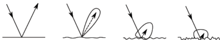
Figure 6 : Direction et puissance du signal réfléchi en fonction de la surface rencontrée
