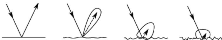
Figure 6 : Direction et puissance du signal reflechi en fonction de la surface rencontrée
