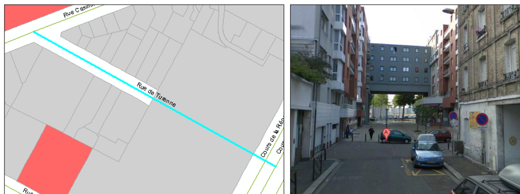
Figure 30 : Illustration d'une voie passant sous un bâtiment
