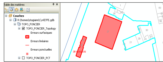
Figure 20 : Mise en évidence d'erreurs topologiques
