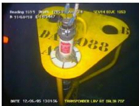
Figure 4: Transpondeur LBL sur son support
