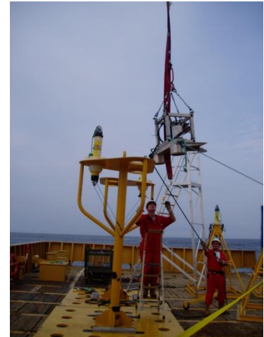
Figure 3 : support destiné à accueillir les transpondeurs LBL pour du positionnement sous-marin
