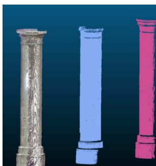
Figure 11 Algorithme RANSAC appliqué à plusieurs colonnes via CloudComapre
