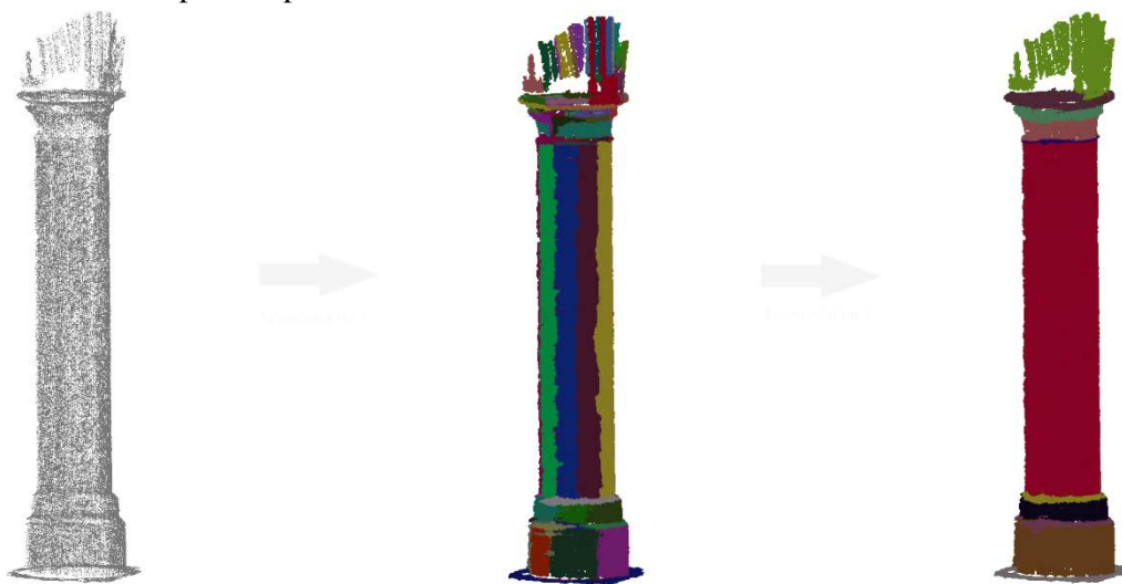
Figure 40 Nuage de point brut (gauche), segmentation 1 (milieu), segmentation 2 (droite)
