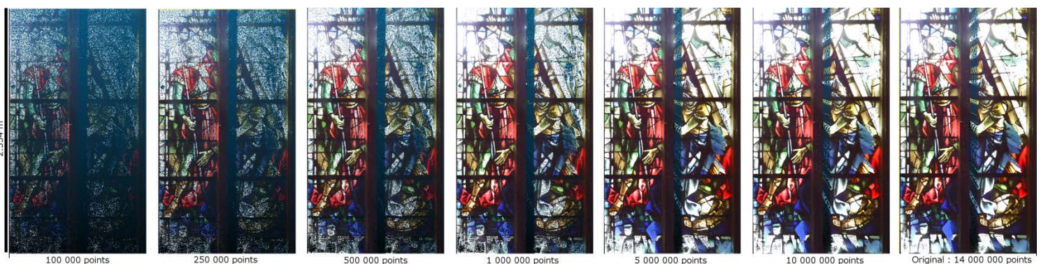
Figure 9 Exemple de différents échantillons de différentes densités appliqués à un vitrail de la cathédrale
