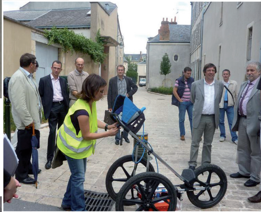
Démonstration du géoradar par la Société IDD
