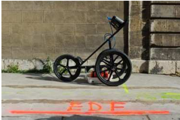
MEDDTL - Arnaud Bouissou Un géoradar, rue de Bretonnerie, à Orléans
