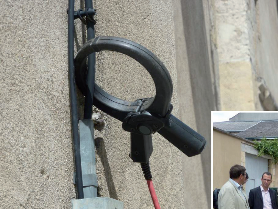
Pince pour détection électromagnétique
