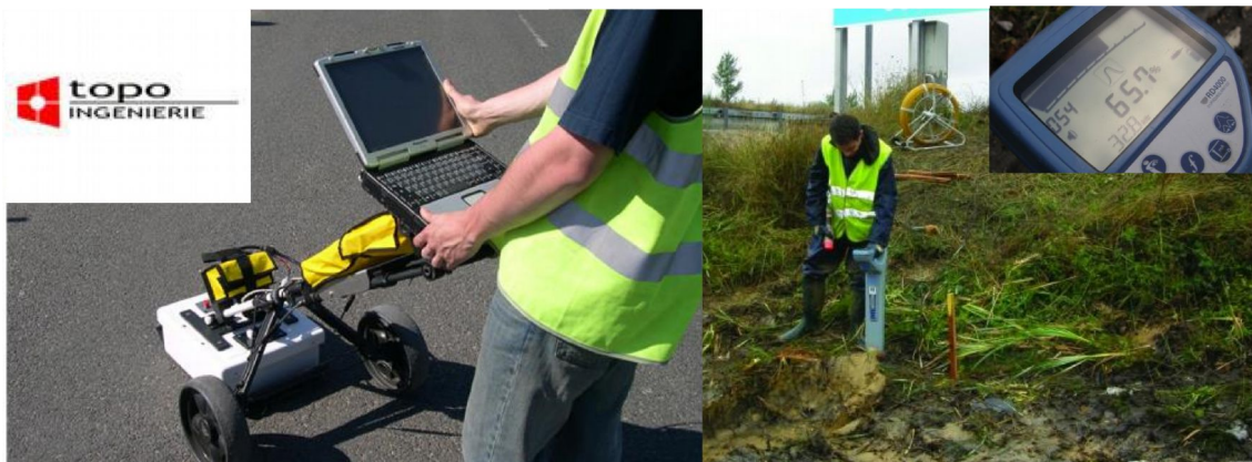
Illustration 4: Photos [14] des deux méthodes d'investigations complémentaires non intrusives: géoradar et radiofréquence
