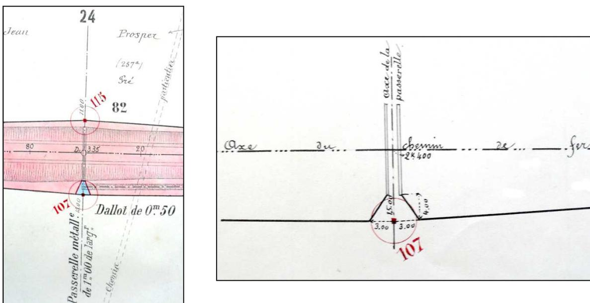
Figure 9: Plan parcellaire des terrains acquis avec bornage de la voie ferrée de Nontron à Sarlat (1902) et croquis de repérage des bornes
