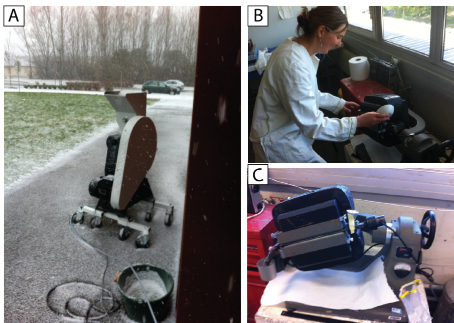
FIGURE 4 – Tri mécanique : A) Broyeuse à mâchoires B) et C) Séparateur magnétique (Frantz) à ISTERre Chambéry
