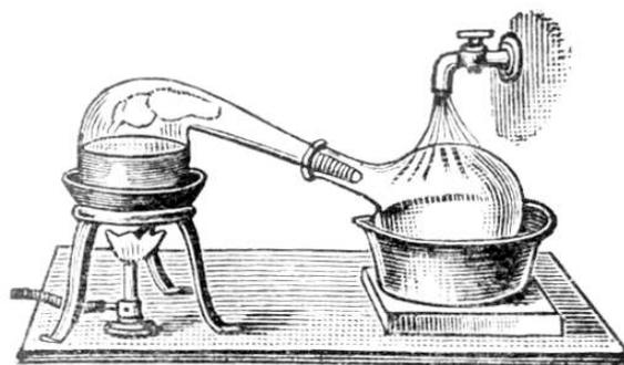
**Figure 4 :** Représentation d'un alambic de laboratoire.
