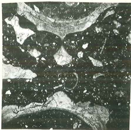
echantillon n° 859 G=25 sections de cerithes dans ciment calcarenite
