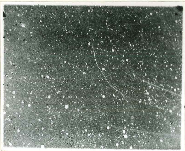
Microfaciés normal des calcaires Barrémien Calcaire microcristallin à nombreux Radiolaires; Spicules .
