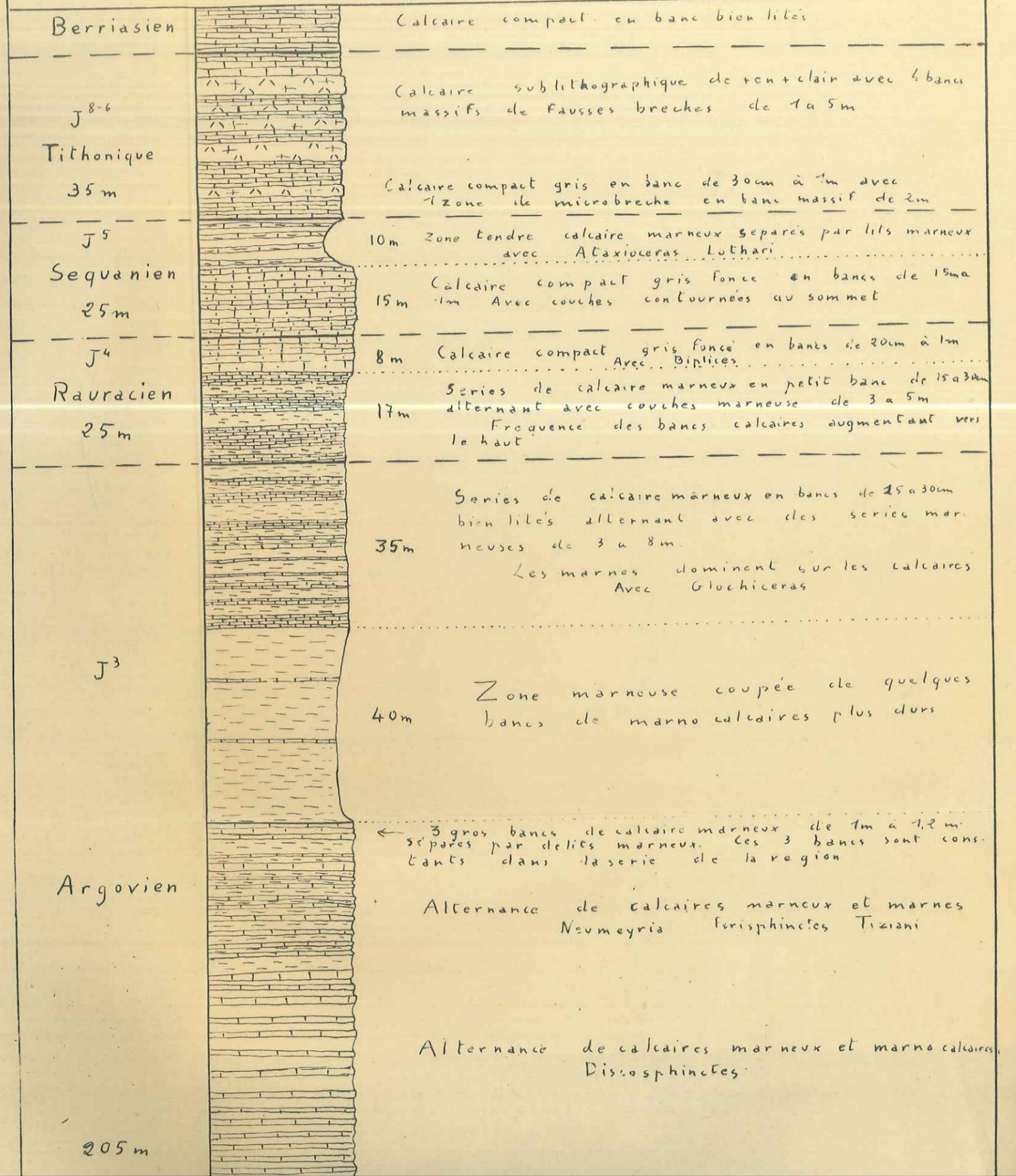
35m Series de calcaire marneux en bancs de 25 à 30cm bien lités alternant avec des séries marneuses de 3 à 8m.
