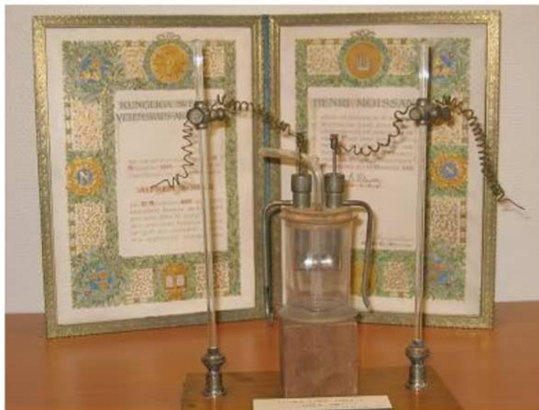
Figure 4 : Diplôme Nobel d'Henri Moissan et cellule électrolytique de production de fluor (Source : musée Moissan)
