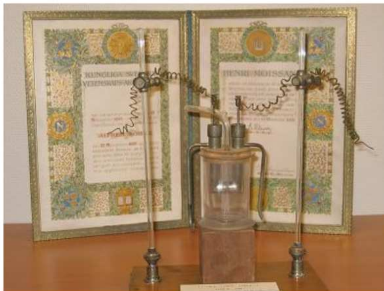
Figure 4 : Diplôme Nobel d'Henri Moissan et cellule électrolytique de production de fluor (Source : musée Moissan)
