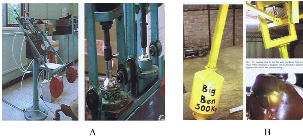
Fig 16 : A. Pendule de Charnley (visible au Whirghtington Museum). B : Pendule élaboré par D. Mc Minn. Images extraites de Modern Hip Resurfacing. Ed Springer 30
