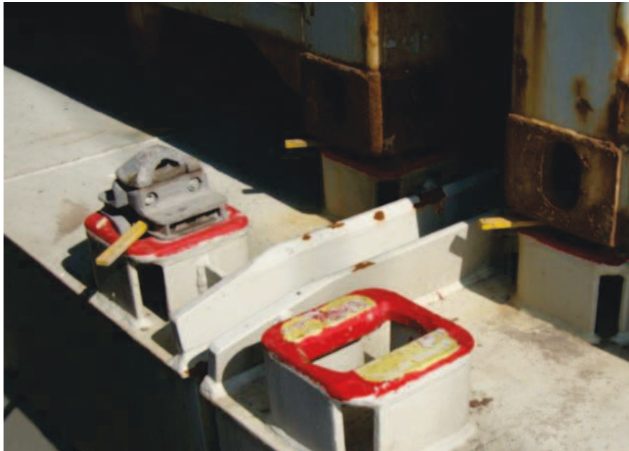
Figure 38. Rails de guidage d'une cale (en haut) et pied de pile avec un twist-lock (en bas).
