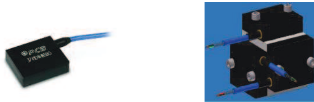
Figure 7. Accéléromètres PCB 3741D4HB2G – Montage pour une mesure 3D.
