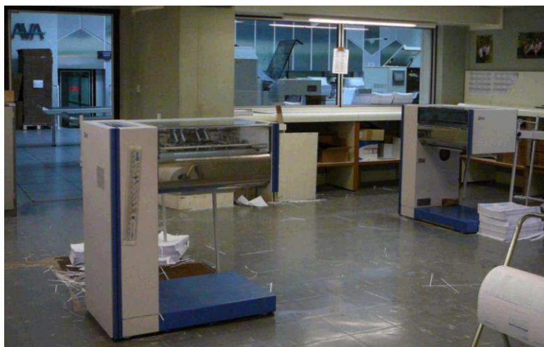
Photo 4 : Massicots permettant de découper les bandes caroll.
