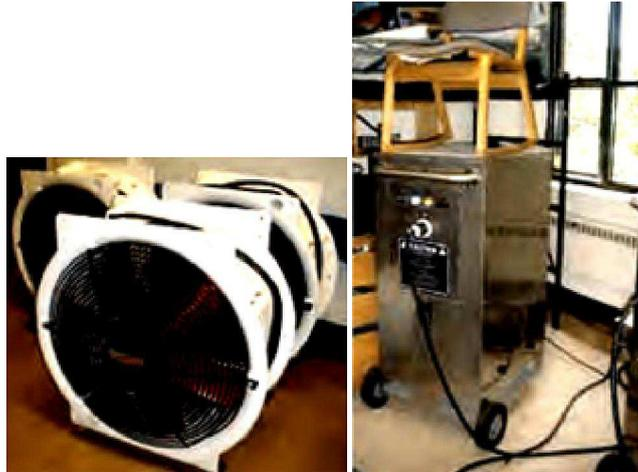
**Figure 36** : ventilateurs à convection et réchauffeurs électriques utilisés dans le traitement thermique (73)
