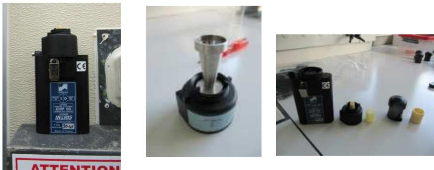
Figure 10 : Capteur d'ambiance, capteur de poussière inhalable, de poussière alvéolaire
