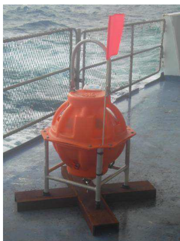
Gauche : MicroOBS+ sur le pont de l'Atalante. Droite : schéma d'un MicroOBS.
