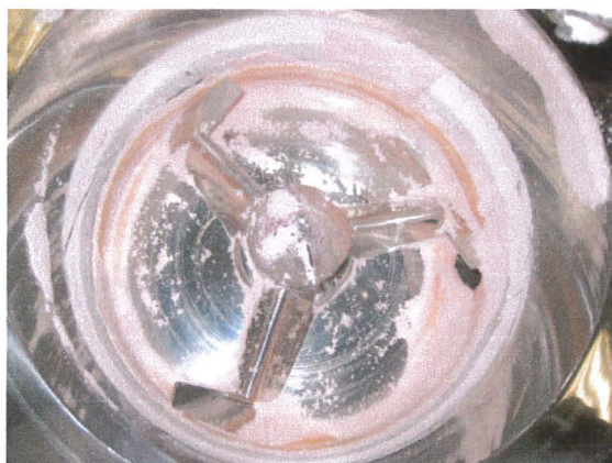
Figure 33 : Encrassage de la cuve
