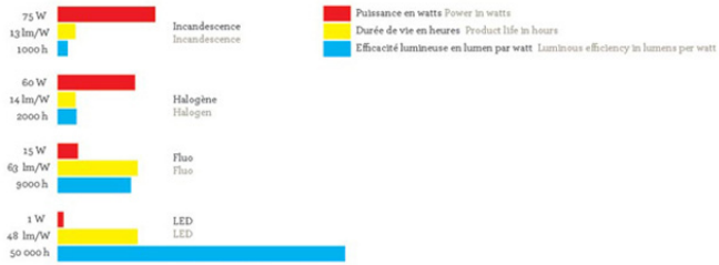
Consommation et efficacité de différents types de sources lumineuse électrique. Consumption and efficiency of various types of electric light sources.
