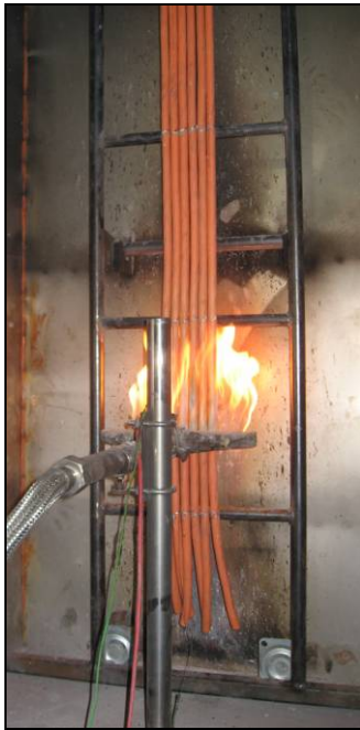
Figure 5.12 : Combustion des câbles sur l'échelle
