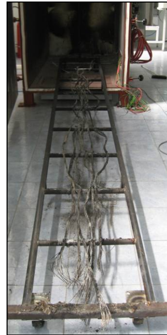
Figure 5.13 : Tronçons de câbles sur l'échelle après l'essai
