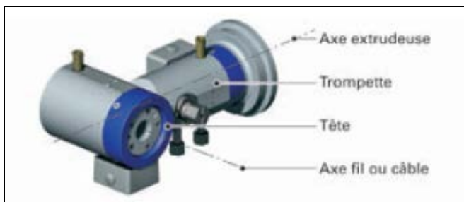
Figure 2.14 : Tête pour l'extrusion des câbles [11]
