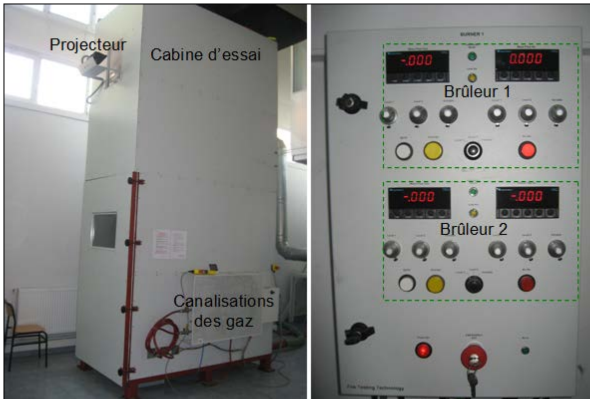
Figure 4.19 : Cabine d'essai de propagation d'incendie et débitmètres
