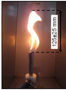
Figure 4.6 : Flamme de diffusion au propane
