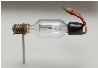
Figure 1 : Réplique de la première diode à vide (Source http://fr.wikipedia.org/wiki/Historique_des_tubes_%C3%A9lectroniques#mediaviewer/File:Triode_tube_1906.jpg Consulté le décembre 2013)
