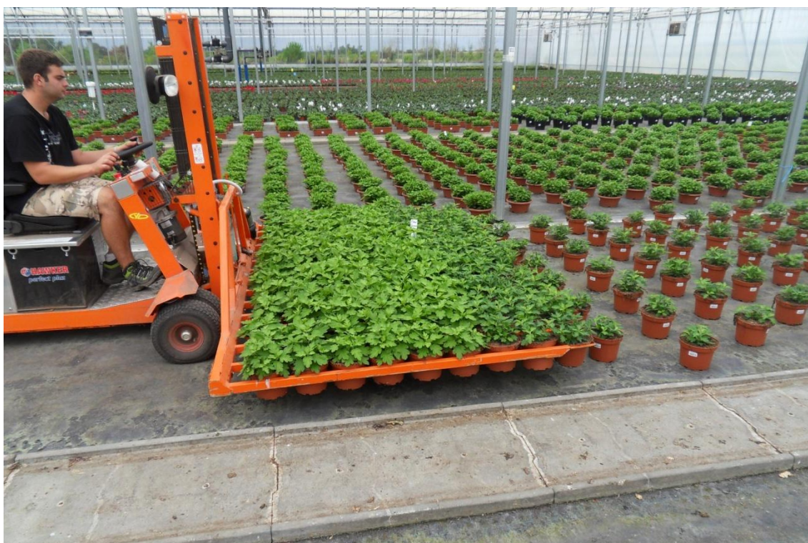
Figure 5: Machine « placeuse, distanceuse » en fonctionnement pour le distançage de chrysanthèmes en pot de 19 (E. Lafay, 2014)
