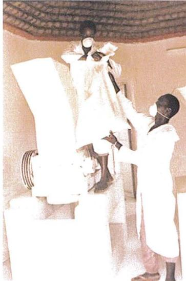
Après le broyage, les trappes d'ouverture des broyeurs sont ouvertes et la poudre de plante est récupérée dans des récipients métalliques pour être tamisée.
