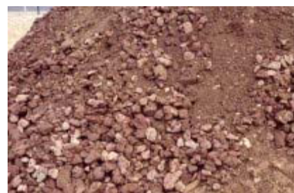
Figure 27 : Photographie d'un tas de MTP avant sa mise en œuvre. La pierre est dominante dans le mélange (Rossignol in Plante et Cité 2008).
