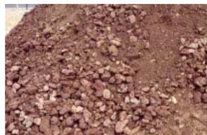
Figure 27 : Photographie d'un tas de MTP avant sa mise en œuvre. La pierre est dominante dans le mélange (Rossignol in Plante et Cité 2008).
