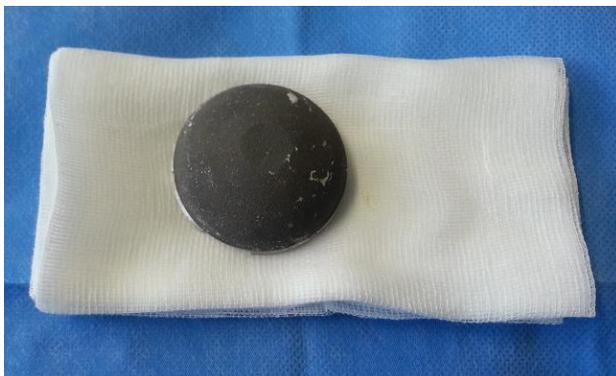
**Figure 11 : faible ostéointégration d'un cotyle Durom® explanté à 3 ans**
