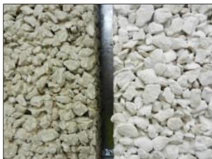
Figure 13 : Béton drainant – produit Gautier Matériaux (Morange L., 2014)
