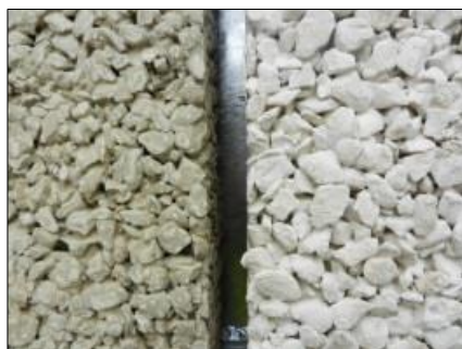
Figure 13 : Béton drainant – produit Gautier Matériaux (Morange L., 2014)
