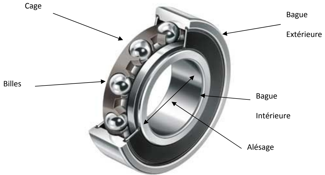
Figure 7: Roulement à billes.
