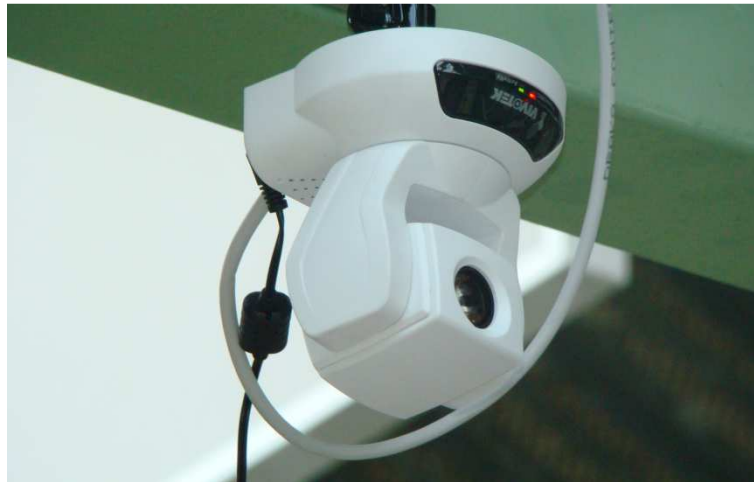
Photo A1.2.1 – Une caméra IP pivotable accessible depuis Internet
