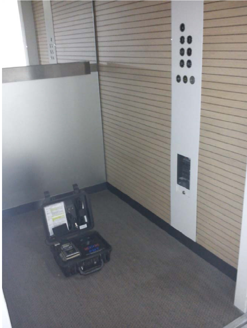
Figure 26 : Appareil de mesure des vibrations PMT dans une cabine d'ascenseur
