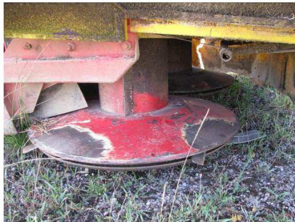
**Figure 12. Récolteuse faucheuse-autochargeuse Supertino en possession de PFA. Vue détaillé du tambour à couteaux cisaillants (Diot, 19/09/14, St Sulpice)**
