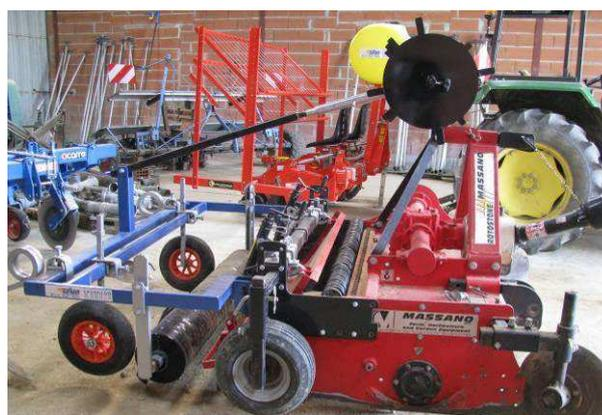
**21. Butteuse-plastifiseuse-dérouleuse utilisée sur le chantier de PFA. (Diot, juin 2014, St Sulpice).**
