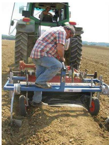
Figure 23. Réglage de la butteuse. (Diot,16/06/14, St Sul.).
