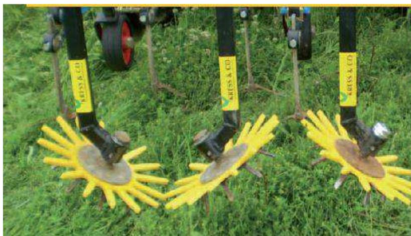
Figure 34. Système de doigts Kress sur bineuse de précision. (CTIFL, 2012).
