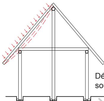
Déformation du chevron sous la poussée de la toiture.
