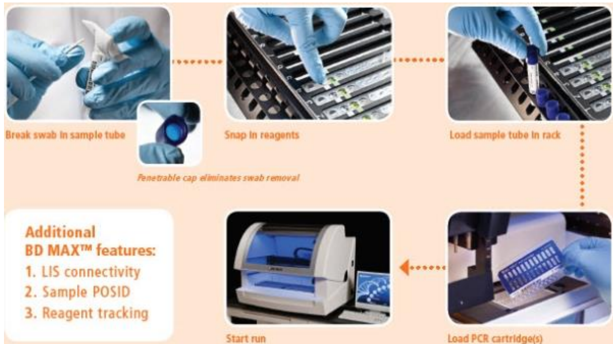
Figure 5 : Procédure simplifiée de réalisation pratique de la technique de préparation des réactions de PCR.
