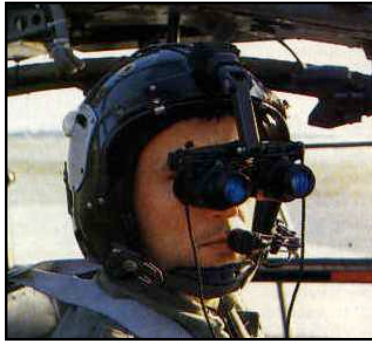
Figure 6 : Pilote équipé d'un casque muni de jumelles à vision nocturne
