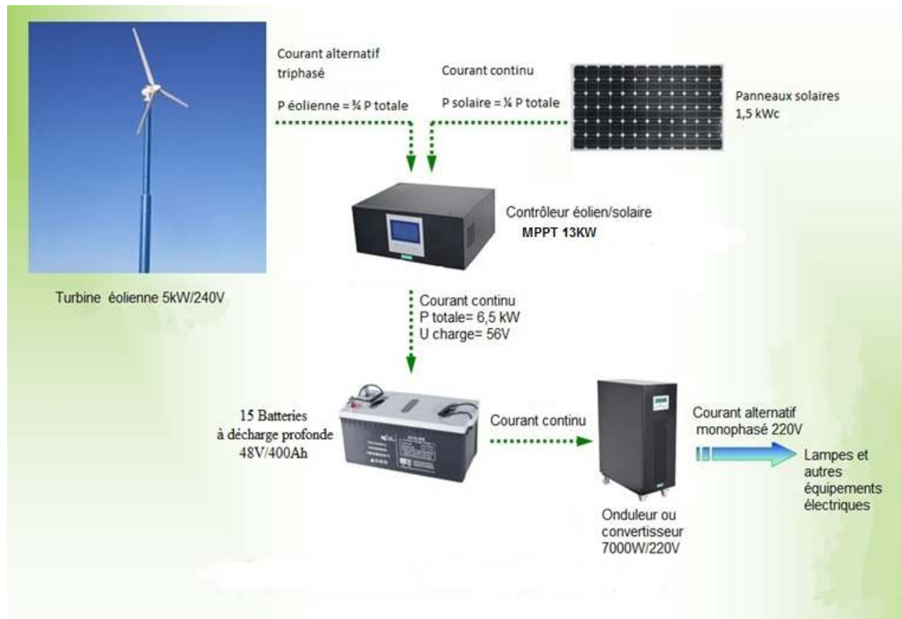
Figure 31 – Schéma englobant les différents composants du projet
