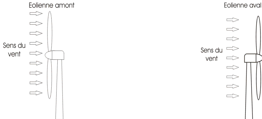
Figure 3 – Eoliennes à axe horizontal
