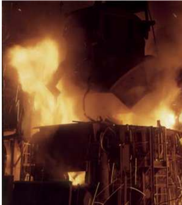
Figure 17 - Chargement du four électrique (Source Siemens)
