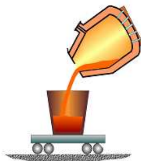
Figure 7 - Vidage du convertisseur (Source ArcelorMittal)
