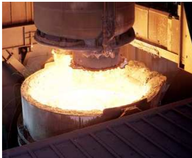
Figure 9 – Dégazage (Source ArcelorMittal)
