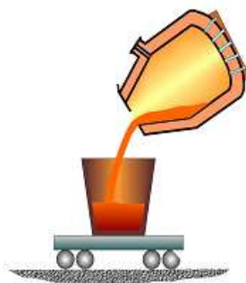
Figure 7 - Vidage du convertisseur (Source ArcelorMittal)
