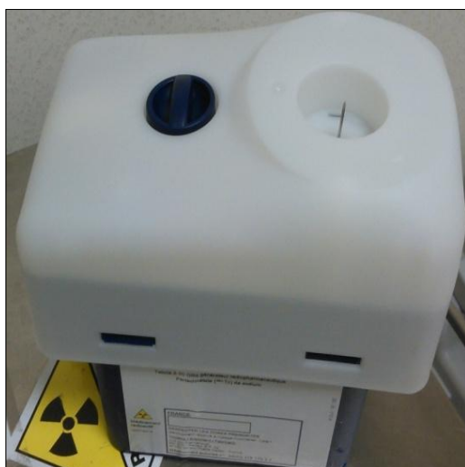
Figure 9. Présentation globale du générateur ^{99}\text{Mo} - ^{99m}\text{Tc}
