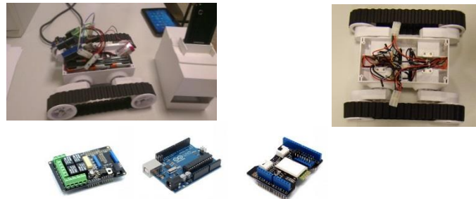
Figure 2 : les composants du robot.
