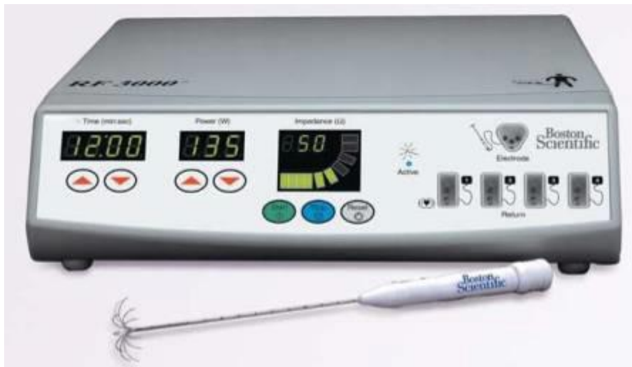
Figure 2 : Générateur RF 3000 (Boston scientific 2009).
